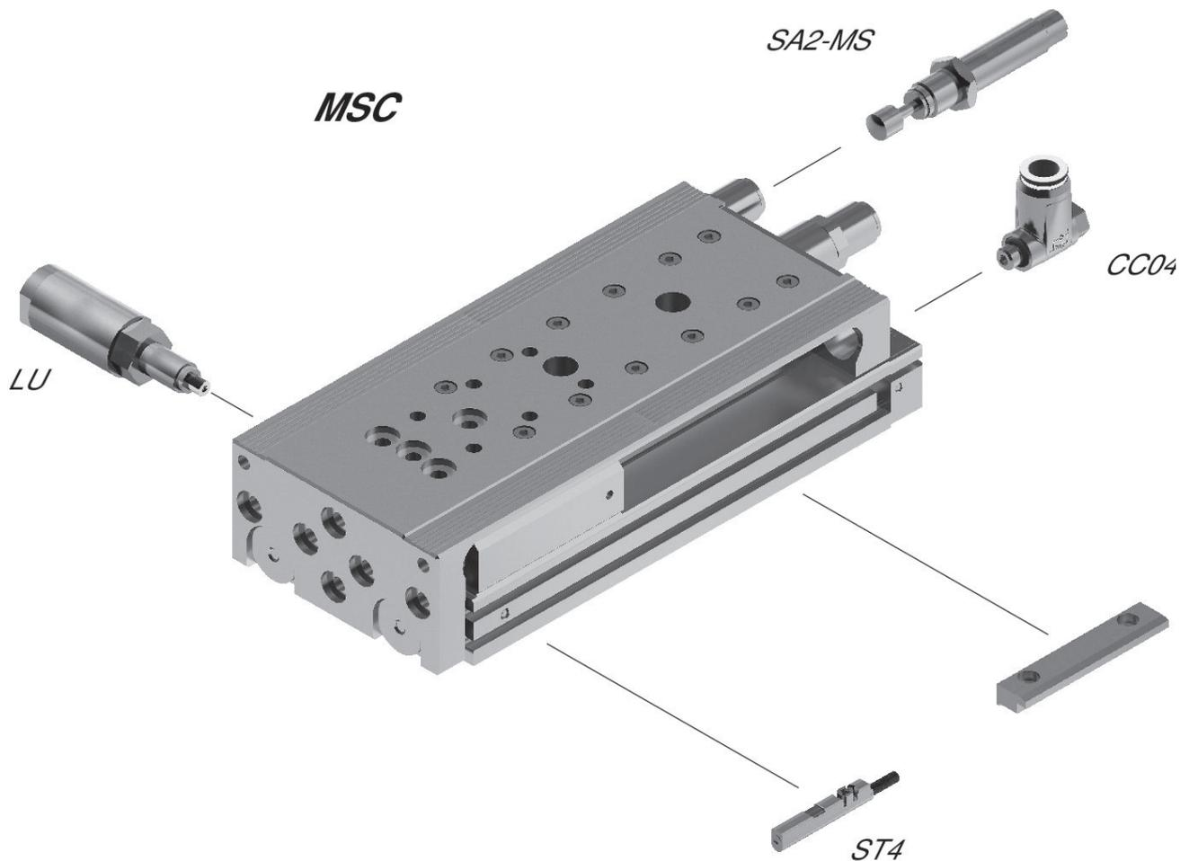
NOTA: Questo disegno di riepilogo serve da orientamento per il punto di fissaggio dei diversi accessori al cilindro. Per questo l'illustrazione è stata semplificata. Non sono consentite deduzioni concrete di dati di misurazione.
