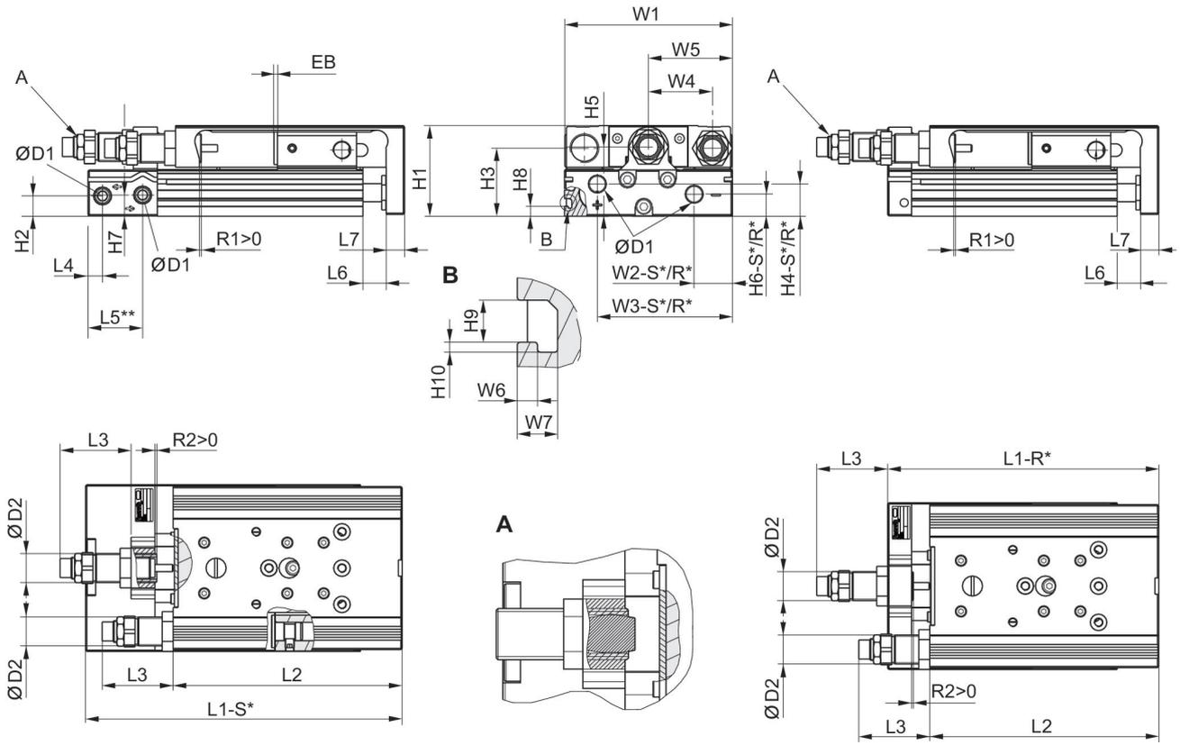
R\*: Bodenausführung mit Luftanschlüssen nur hinten
