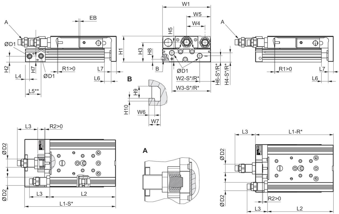
R\*: Bodenausführung mit Luftanschlüssen nur hinten
