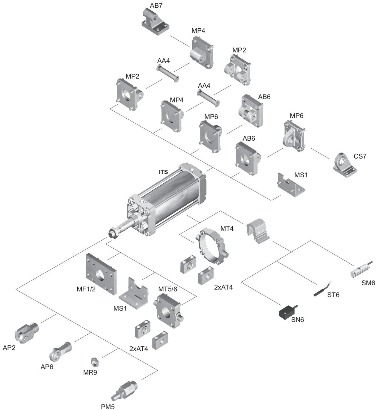
HINWEIS: Diese Übersichtszeichnung dient zur Orientierung, an welcher Stelle die unterschiedlichen Zubehörteile am Zylinder befestigt werden können. Dazu wurde die Darstellung vereinfacht. Eine konkrete Ableitung maßlicher Gegebenheiten ist deshalb nicht zulässig.
