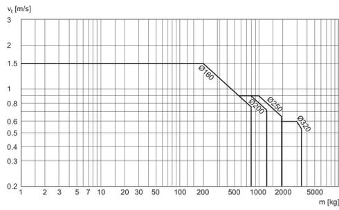
$v_1$  = Velocidad del pistón [m/s]  $m$  = Masa amortiguada [kg]
