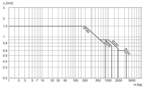
$v_1$  = velocità pistone [m/s]  $m$  = massa ammortizzabile [kg]
