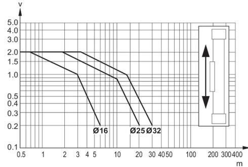
$v_1$  = velocità pistone [m/s] m = massa ammortizzabile [kg]
