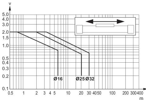
$v_1$  = velocità pistone [m/s] m = massa ammortizzabile [kg]
