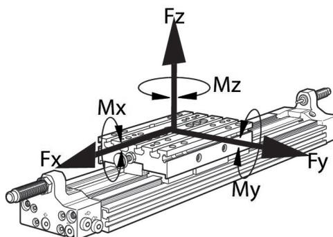
No caso de torques simultâneos no cilindro, esta fórmula deve ser empregada adicionalmente para o controle do torque máximo. Na fase de amortecimento do movimento, existe a atuação adicional de forças
