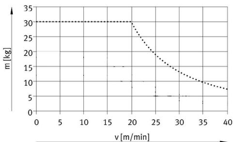
Máx. Carga radial admisible del cojinete F durante la operación de conmutación
