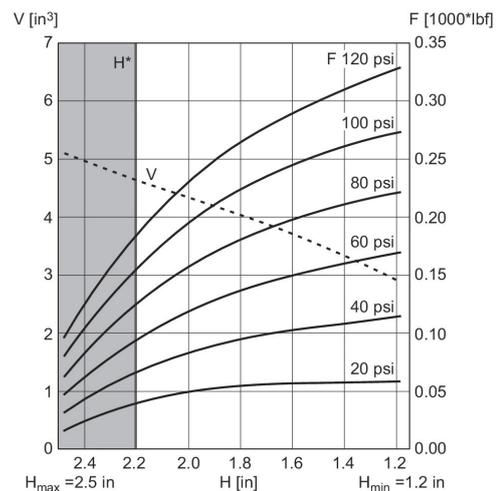
V = Volume H = Altura H\* = Altura de operação recomendada para isolamento da vibração H\*\* = Utilização apenas após contato com a AVENTICS
