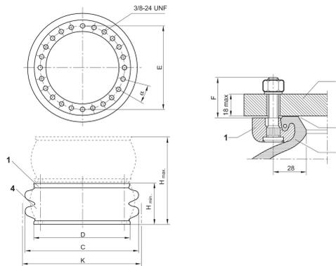
sección transversal parcial del anillo de fijación montado con perno roscado
