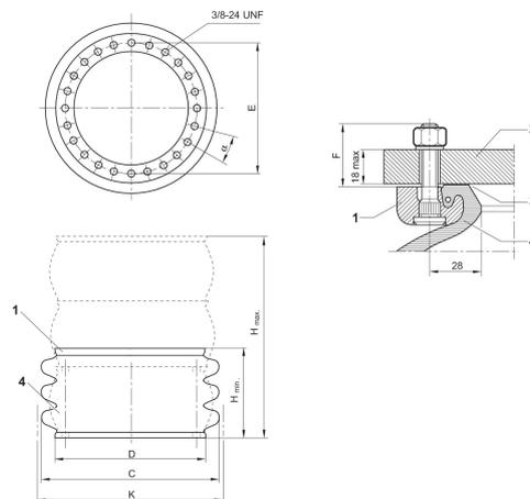
Teilquerschnitt des eingebauten Befestigungsringes mit Stehbolzen 1. Befestigungsring 2. Maschinenteil 3. Dichtfläche \*) 4. Balg \* Empfehlung
