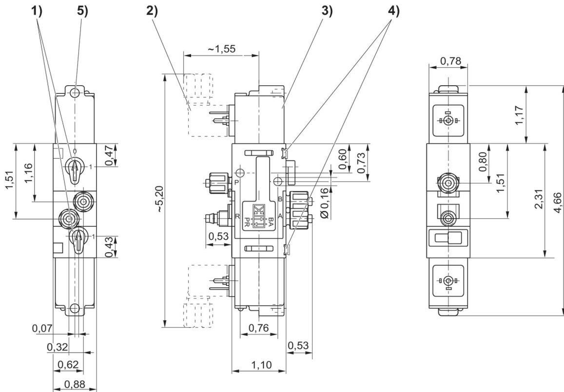
1) Hand Hilfsbetätigung 2) Ventilsteckverbinder 3) Spule ist um 180° drehbar 4) Befestigungsmöglichkeit für Bezeichnungsschild 5) Bohrung für M5-Verschraubung oder Schalldämpfer Ø 4,5 mm
