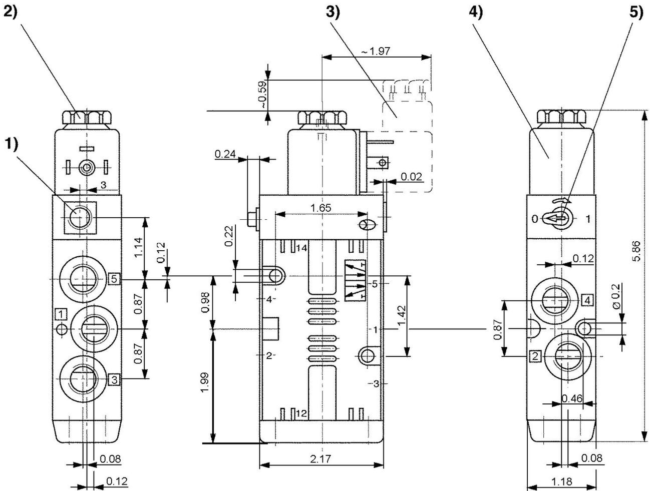
1) Solo con pilotaggio separato G 1/8 2) dopo la rimozione del coperchio filettatura interna M5 3) connettore valvola
