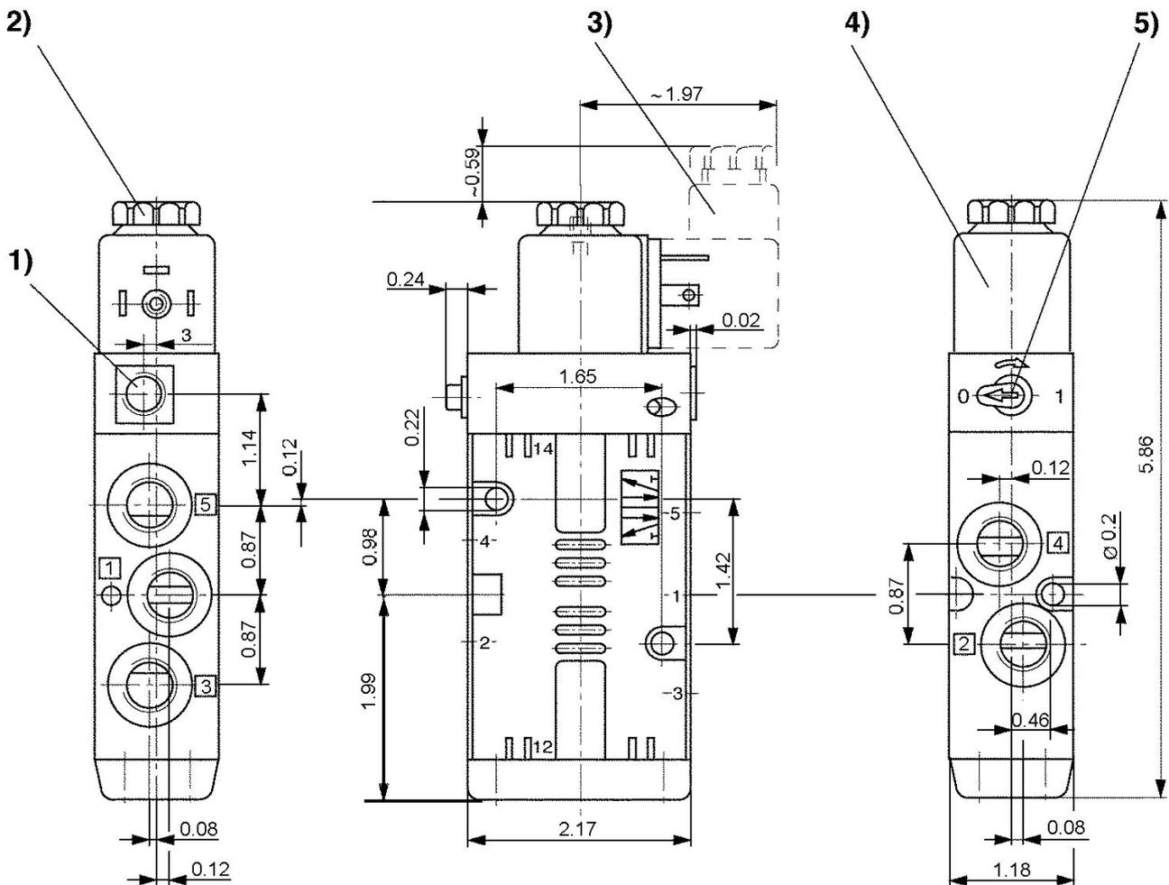
1) Nur bei separater Vorsteuerung G 1/8 2) nach Entfernen der Kappe Innengewinde M5 3) Ventilsteckverbinder 4) Spule jeweils um 45° steckbar 5) Handhilfsbetätigung
