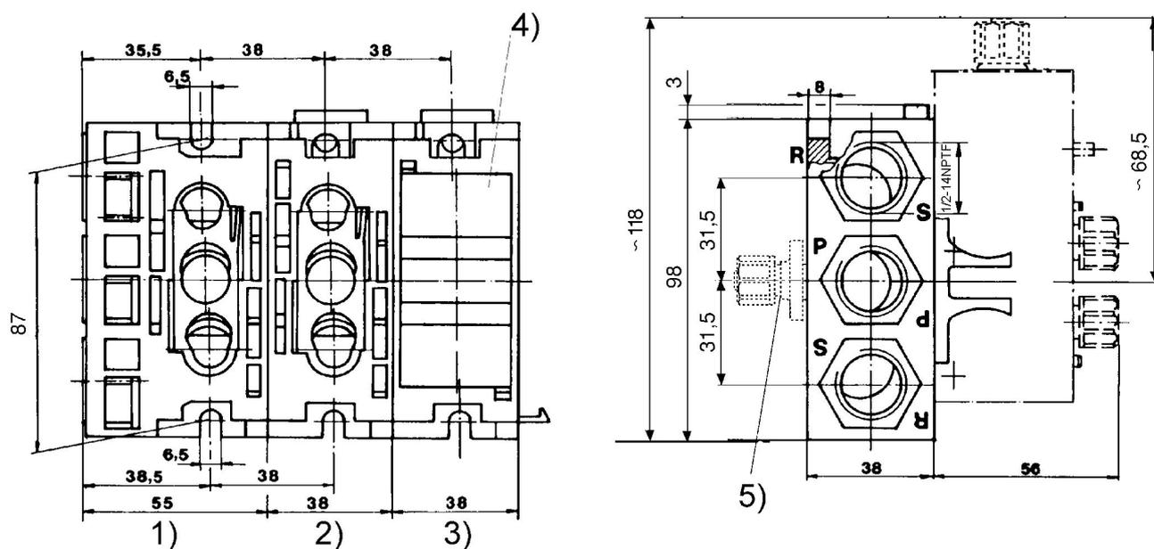
Coppia di serraggio per tutte le viti max. 35 Nm. 1) Piastra di alimentazione 2) Piastra intermedia 3) Piastra terminale 4) Flangia cieca 5) Adattatore per raccordo pneumatico separato
