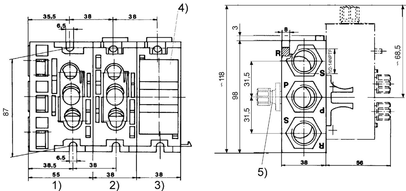
Couple de serrage de toutes les vis : 35 Nm maxi 1) Embase d'entrée 2) Embase intermédiaire 3) Plaque terminale 4) Plaque d'obturation 5) Adaptateur pour raccordement pneumatique séparé
