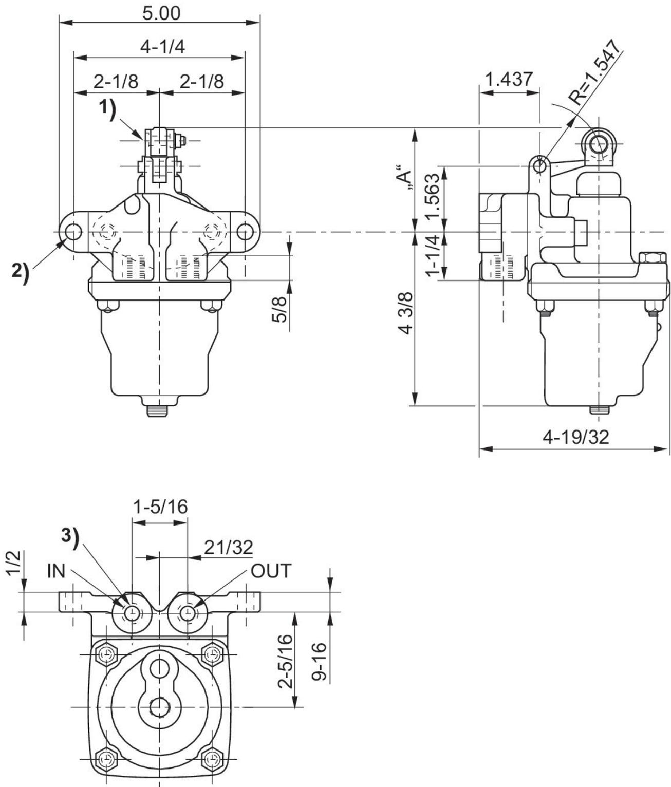
1) Exzentrerschraube 0,031 Zoll für eine Rollenverstellung von insgesamt 0,062 Zoll zum Erhalt des Maßes "A" von 2,531 Zoll
