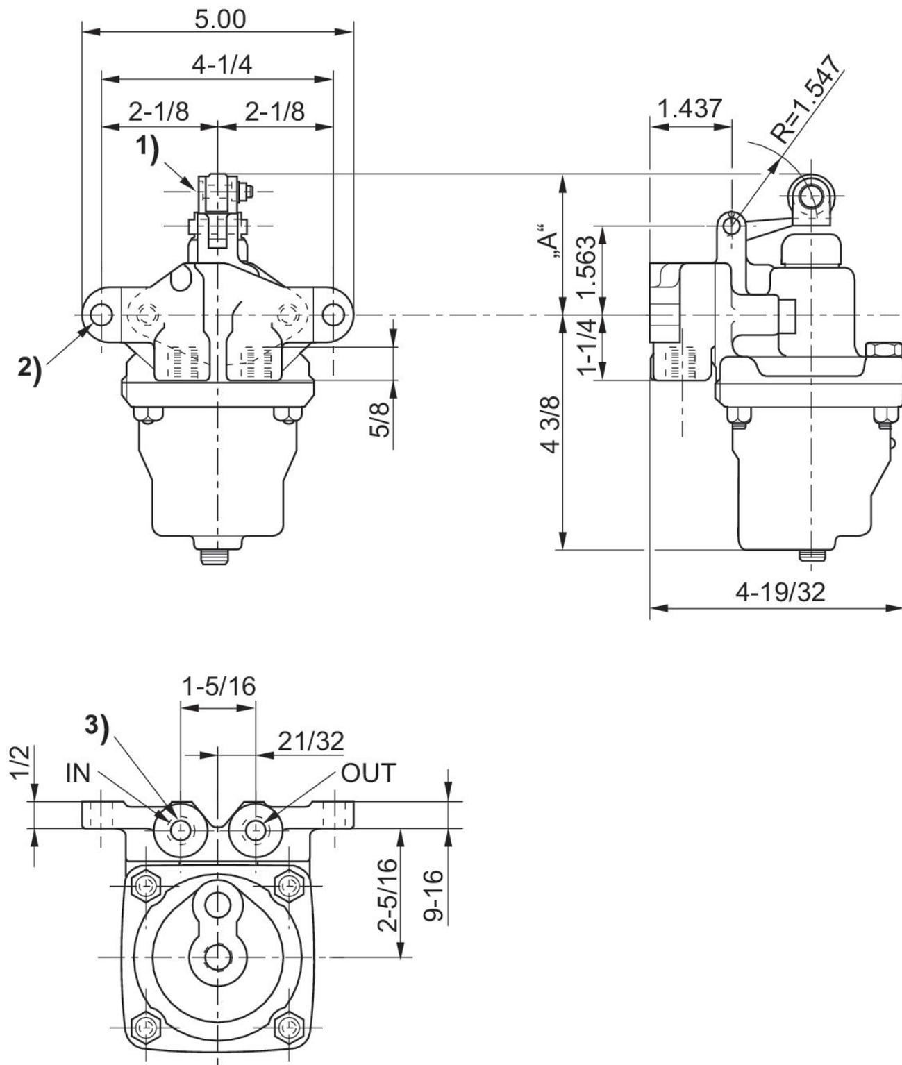
1) Vis excentrique 0,031 pouce pour un ajustage des rouleaux de 0,062 pouce au total, afin de conserver la dimension « A » de 2,531 pouces
