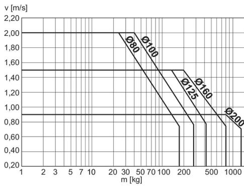
v = Kolbengeschwindigkeit [m/s] m = Dämpfbare Masse [kg]
