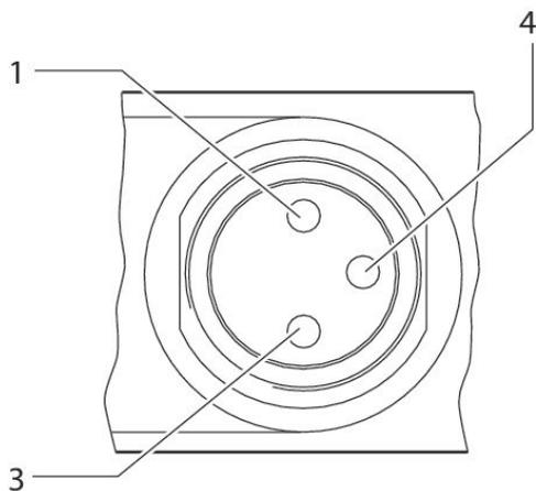
1) ピン割り当てなし 3) 0 V 4) 24 V 指示: 過圧防止用ハイボラ保護回路
