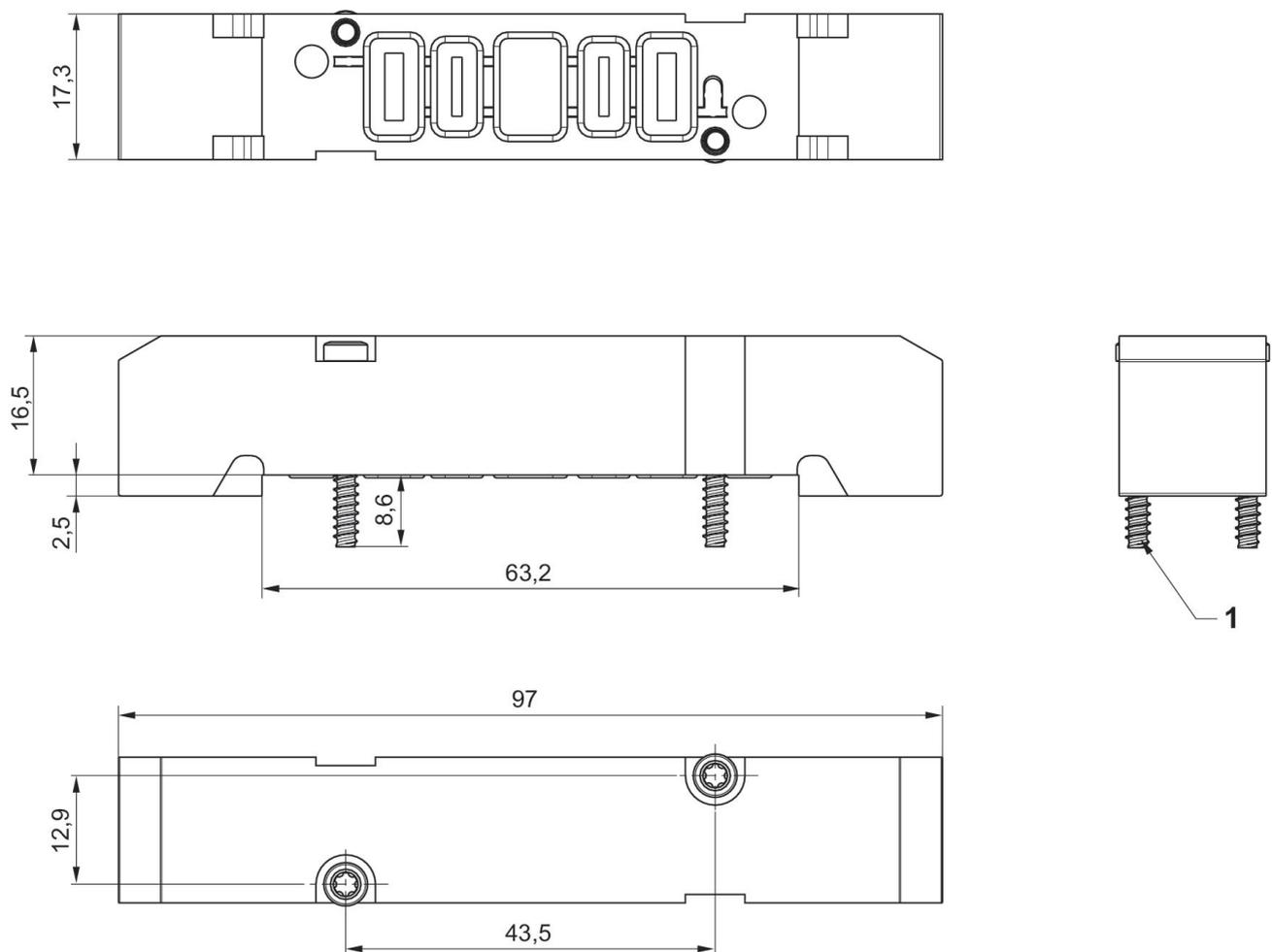
1) Parafusos para plástico Ø3
