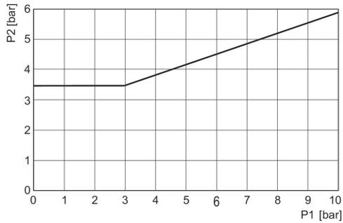
p1 = pressione sull'attacco 2 e 4, p2 = pressione di pilotaggio
