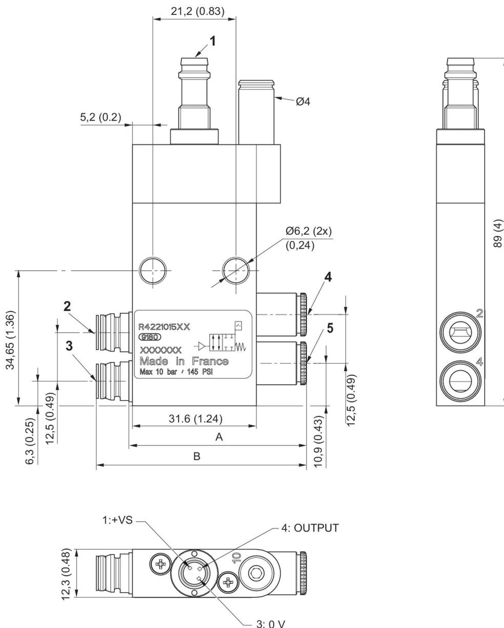
1) Connecteur de capteur M8, à 3 pôles
