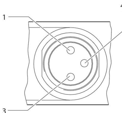
1) Pin no ocupado 3) 0 V 4) 24 V Nota: Circuito de protección bipolar contra la sobretensión
