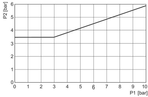
p1 = presión en conexión 2 y 4, p2 = presión de pilotaje
