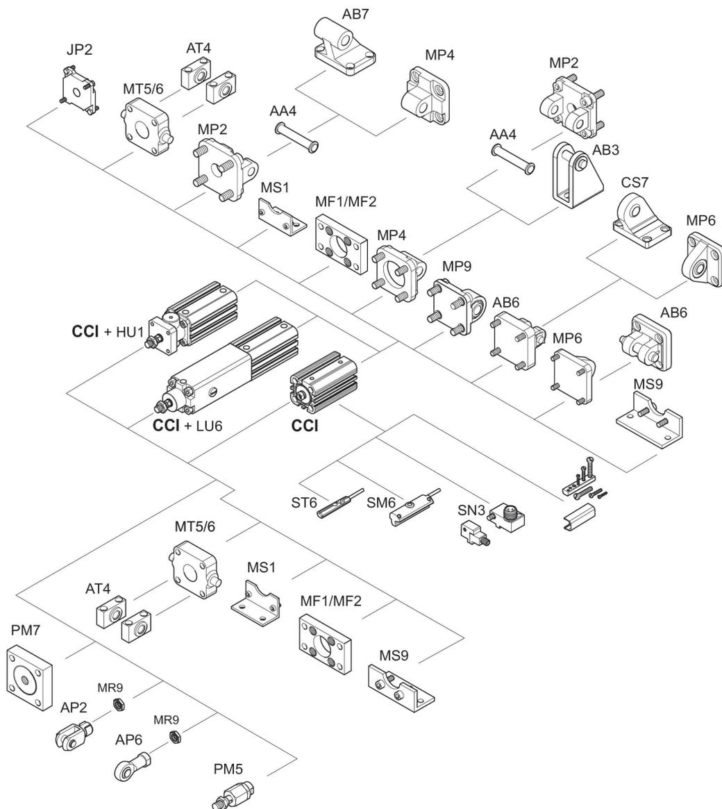
NOTA: Questo disegno di riepilogo serve da orientamento per il punto di fissaggio dei diversi accessori al cilindro. Per questo'illustrazione è stata semplificata. Non sono consentite deduzioni concrete di dati di misurazione.
