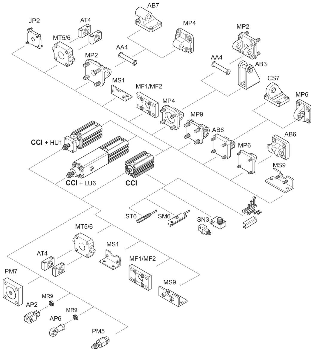
NOTA: Questo disegno di riepilogo serve da orientamento per il punto di fissaggio dei diversi accessori al cilindro. Per questo l'illustrazione è stata semplificata. Non sono consentite deduzioni concrete di dati di misurazione.
