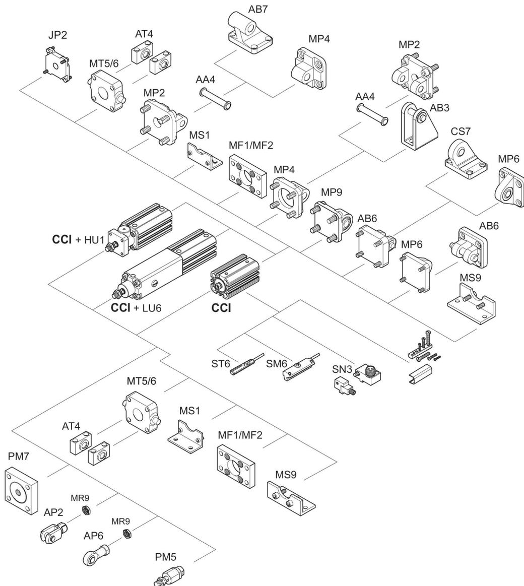
NOTA: Este desenho com uma vista geral serve como orientação para os locais onde os diferentes acessórios podem ser fixados no cilindro. A ilustração foi simplificada para este fim. Por isso, não devem ser tiradas conclusões quanto às verdadeiras medidas e dimensões das peças.
