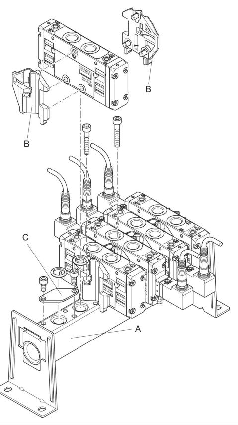
Pour le montage des distributeurs, il faut commander : l'embase multiple A et le kit de fixation B C = Plaque d'obturation
