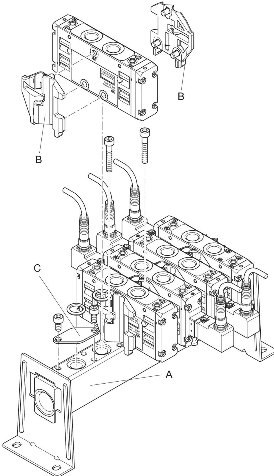
Zur Montage der Ventile müssen bestellt werden: Sammelanschlussleiste A und Befestigungssatz B
