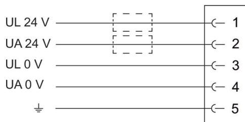
Conector redondo del sensor M12x1, de 5 polos, conector de montaje, codificado A
