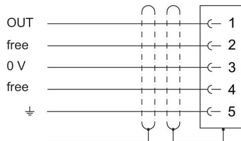
Conector redondo de sensor M12x1, 5 polos, conector hembra incorporado, codificado A
