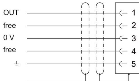
Connecteur rond capteur M12x1, à 5 pôles, douille incorporée, codé A
