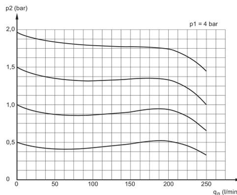
p1 = Betriebsdruck p2 = Sekundärdruck qn = Nenndurchfluss
