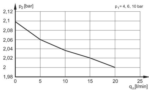
p1 = Betriebsdruck p2 = Sekundärdruck qn = Nenndurchfluss
