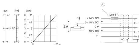
1) Versorgungsspannung 2) Potentiometerspeisung (Pin 4) und Sollwert (Pin 2) sind auf 0 V bezogen. Widerstand des Potentiometers min. 0-2 kΩ, max. 0-10 kΩ. 3) Die Betriebsspannung muss mit einer externen Sicherung M 0,5 A abgesichert werden. Zur Gewährleistung der EMV ist der Stecker über ein geschirmtes Kabel anzuschließen.
