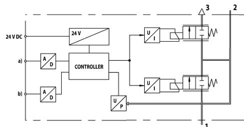
a) Sollwerteingang b) Istwertausgang Das E/P Druckregelventil steuert entsprechend einem analogen elektrischen Sollwert einen Druck aus.
