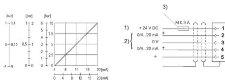
1) Versorgungsspannung 2) Istwert (Pin 4) und Sollwert (Pin 2) sind auf 0 V bezogen. Strom-Ansteuerung (Bürde 100 Ω). Istwertausgang (max. Gesamtwiderstand der nachgeschalteten Geräte < 500 Ω). 3) Die Betriebsspannung muss mit einer externen Sicherung M 0,5 A abgesichert werden. Zur Gewährleistung der EMV ist der Stecker über ein geschirmtes Kabel anzuschließen.
