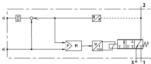
a) Sollwerteingang c) Schaltausgang (Quittierungssignal) Das E/P Druckregelventil steuert entsprechend einem analogen elektrischen Sollwert einen Druck aus.
