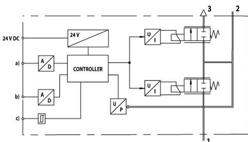
a) 目標値入力 b) 実際値出力 c) 切換出力 (応答信号) E/P 調圧弁はアナログの電気目標値に対応する圧力を制御します。
