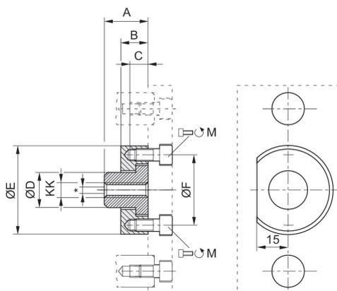
\* 1.0 ... 2.5 mm の半径方向の補正
