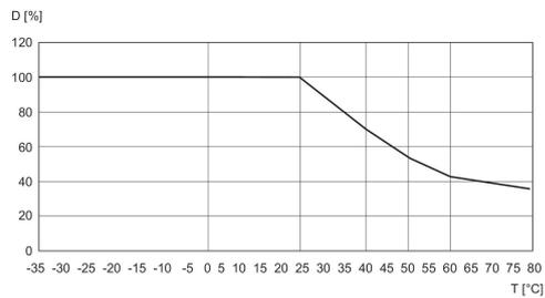
D = Resistencia a la presión T = Temperatura
