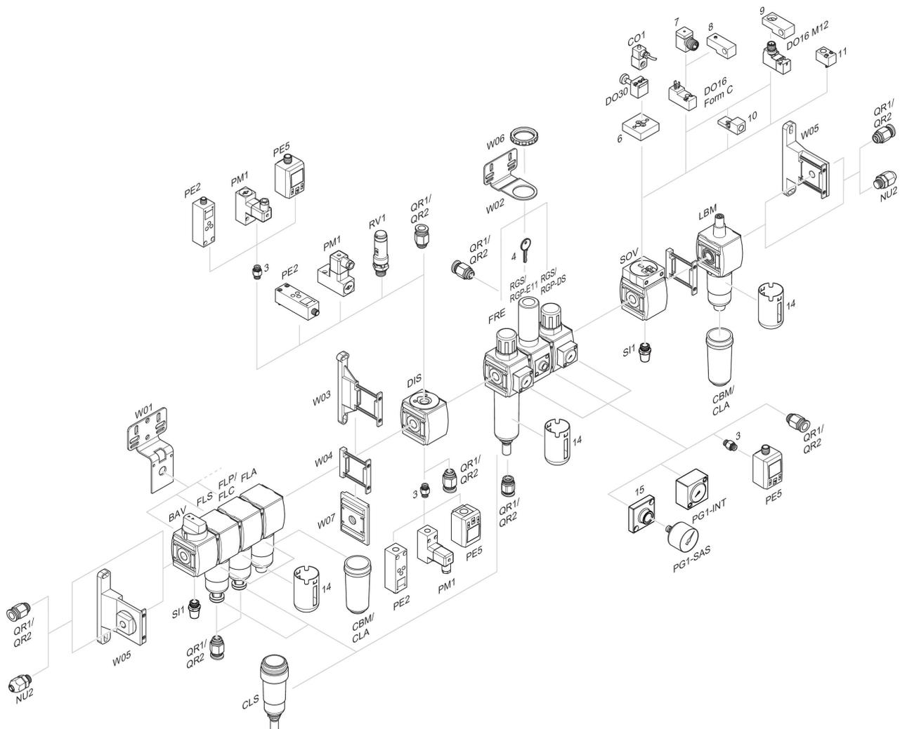
3 = Double manchon 4 = Clé pour fermeture E11 6 = Plaque d'adaptation DO30 7 = Adaptateur, Série CON-VP 8 = Aide au montage DO16, Forme C 9 = Aide au montage DO16, M12 10 = Adaptateur air de pilotage externe 11 = Adaptateur Commande pneumatique 14 = Capot de protection 15 = Plaque d'adaptation pour montage d'un manomètre à l'aide du raccordement fileté G 1/8
