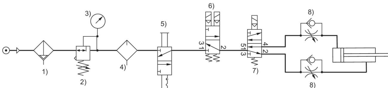
1) Filtre 2) Régulateur de pression 3) Manomètre 4) Lubrificateur 5) Distributeur de verrouillage 6) Soupape de purge de sécurité, série SV 7) Distributeur pilote 5/2 8) Limiteur de débit unidirectionnel
