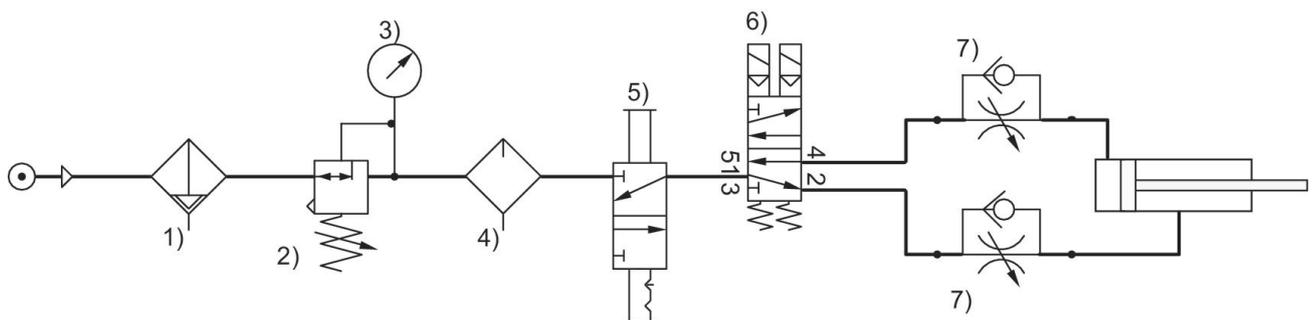
1) Filtro 2) Riduttore di pressione 3) Manometro 4) Lubrificatore 5) Valvola di bloccaggio 6) Valvola di sicurezza, Serie SV 7) Valvola di strozzamento antiritorno
