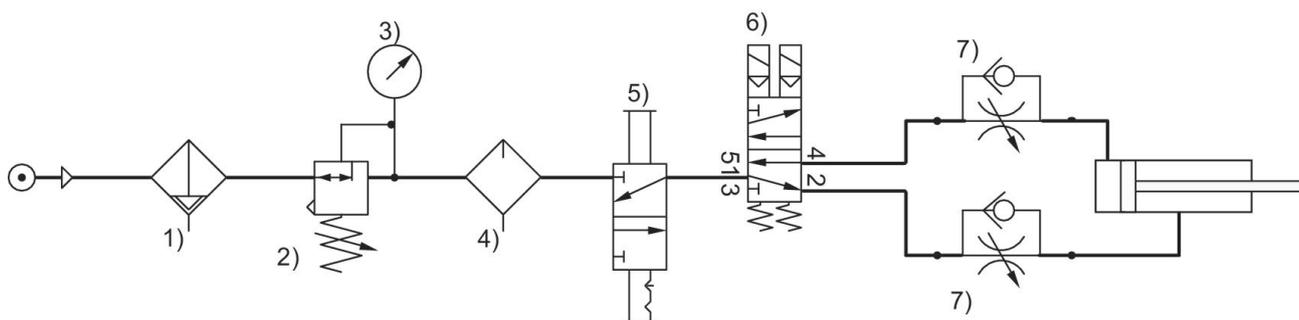
1) Filtre 2) Régulateur de pression 3) Manomètre 4) Lubrificateur 5) Distributeur de verrouillage 6) Distributeur de sécurité, Série SV 7) Limiteur de débit unidirectionnel
