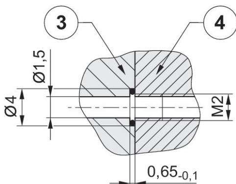
Il collegamento diretto serve per l'alimentazione della pressione senza sistemi di tubi flessibili sensibili ai guasti. Il mezzo di pressurizzazione viene invece convogliato tramite fori nella piastra di collegamento a vite.
