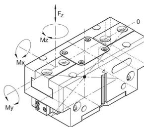
Os momentos e as forças indicadas são valores estáticos, aplicam-se por apoio básico e podem verificar-se em simultâneo. My pode verificar-se, adicionalmente, ao momento gerado pela força de aperto.
