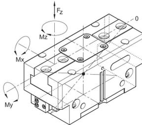
Die angegebenen Momente und Kräfte sind statische Werte, gelten je Grundbacke und dürfen gleichzeitig auftreten. My darf zusätzlich zu dem durch die Greifkraft erzeugten Moment auftreten.
