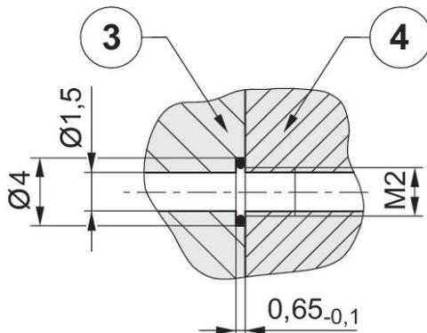
Der Direktanschluss dient zur Druckversorgung ohne störanfällige Verschlauchung. Das Druckmedium wird stattdessen durch Bohrungen in der Anschraubplatte geführt.
