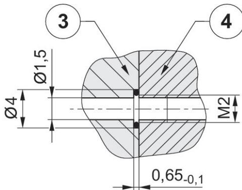
La conexión directa sirve para la alimentación de presión sin un sistema de mangueras propenso a averías. En lugar de eso, el fluido de presión circula a través de los agujeros en la placa de fijación.
