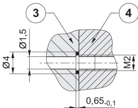
A conexão direta serve para a alimentação da pressão sem tubagens sensíveis a interferências. Em vez disso, o suporte de impressão é conduzido através de perfurações na placa de parafusamento.
