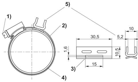
1) Vite di fissaggio 2) Fascetta regolabile 3) Passaggio per fascetta regolabile 4) Canna del cilindro 5) Portasensori
