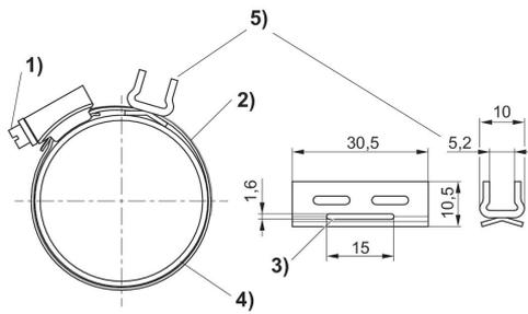
1) Befestigungsschraube 2) Spannband 3) Durchlass für Spannband 4) Zylinderrohr 5) Sensorhalterung
